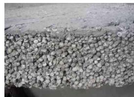
Doziranje EKOPOR granulata za dobivanje 200 litara laganog termobetona (u mješalici za beton).
